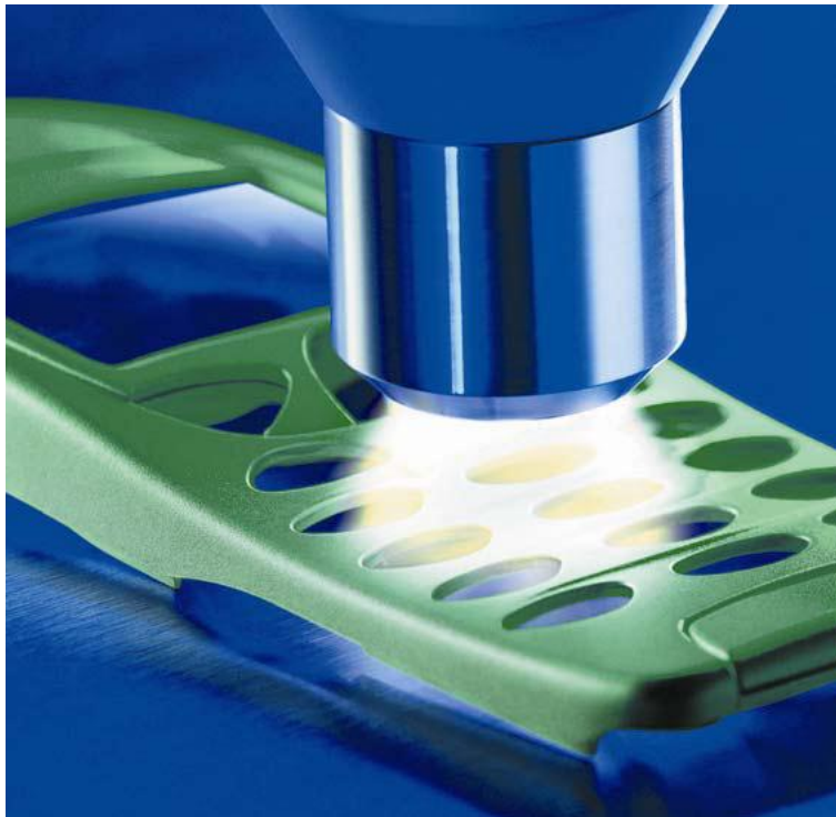
Figuur 1 : Voorbehandeling met Openair plasma verzekert microfijne reiniging van telefoon behuizingen net voor het lakken
